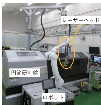
図3 レーザークラッド複合研削盤試験機 Prototype laser cladding and grinding machine
