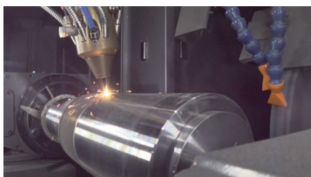
図4 試験機によるレーザークラッド加工 Laser cladding process on prototype machine
