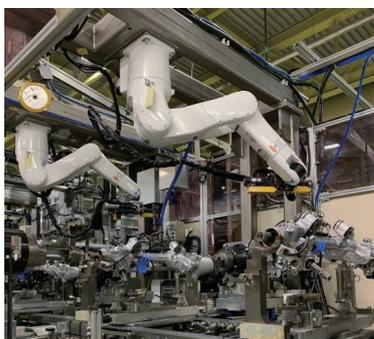
図8 ロボットアームによる複数部品の組立て
