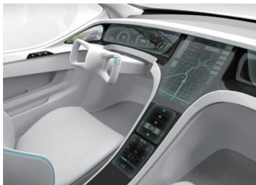
図4 ヨーク型ハンドルを使用したコックピット例 Cockpit with a yoke steering wheel
