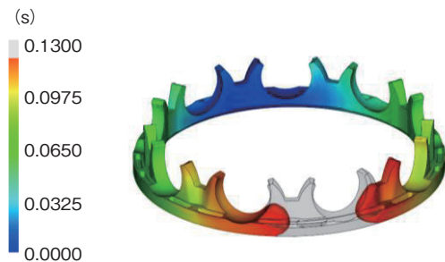
図6 樹脂流動シミュレーション Simulation by resin flow analysis
