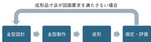
図1 試作金型開発の現行プロセス Current prototype mold development flow
