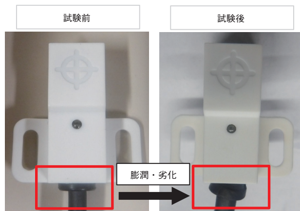
図3 CR 製ブッシング 薬品浸せき試験結果 Results of chemical immersion test for CR bushing
