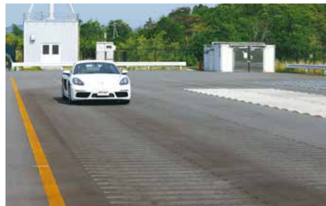
ランブルストリップス路 Rumble-strips Course
