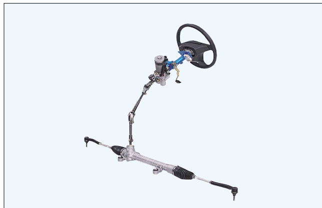
小型車用コラムタイプ電動パワーステアリング
