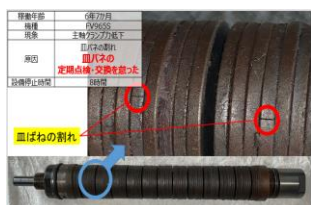
<シパル破損によるクランプ力低下>
