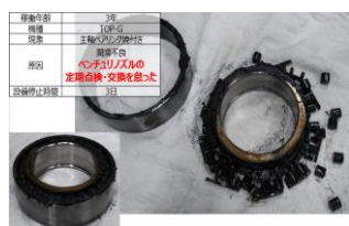
<潤滑不良による主軸ベアリング焼付>
