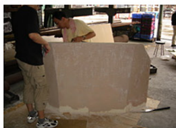
発砲スチロールを削り出して 型を作っています
