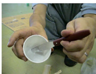
そして、エポキシ系接着剤で接 合していきます
