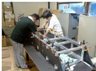
アルミフレームとF R P材を接着します
