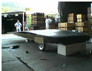
F R Pシートが固まったら、中の発砲スチロールをかき出していきます
