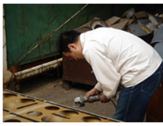
サンダーでボディの上面部と下面部を切り離しています
