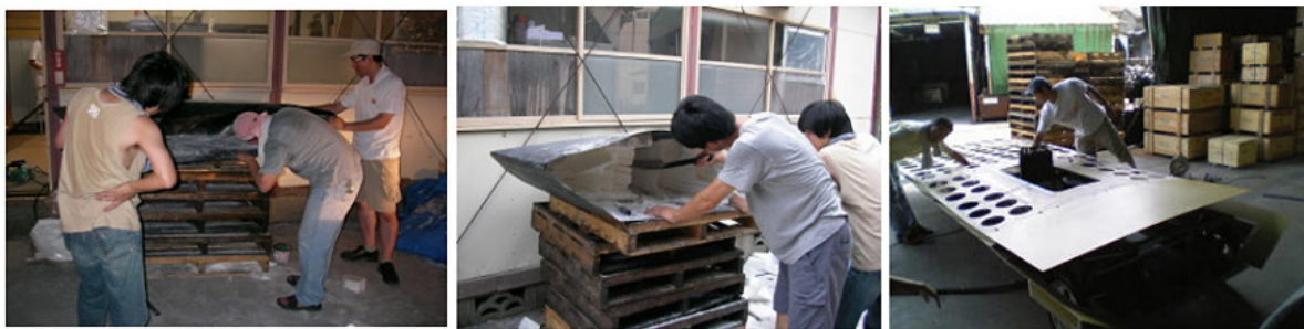
F R Pシートが固まったら、中の発砲スチロールをかき出していきます
