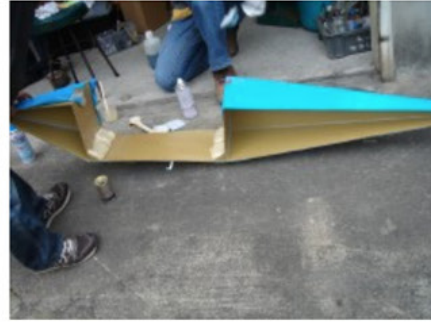
空力性能アップのため、タイヤカバーも 改良です
