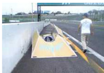
ボディがシャシーと分離して、折れ曲がっています
