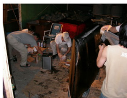
F R Pのシートを型の上に貼り付けていきます
