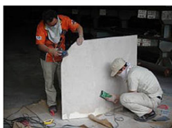
発砲スチロールを削り出して 型を作っています
