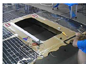
破損の激しい車体前部を切り離し
