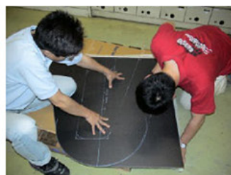
型紙にあわせ軽量F R P材を切り出します
