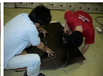
型紙にあわせ軽量F R P材を切り出します
